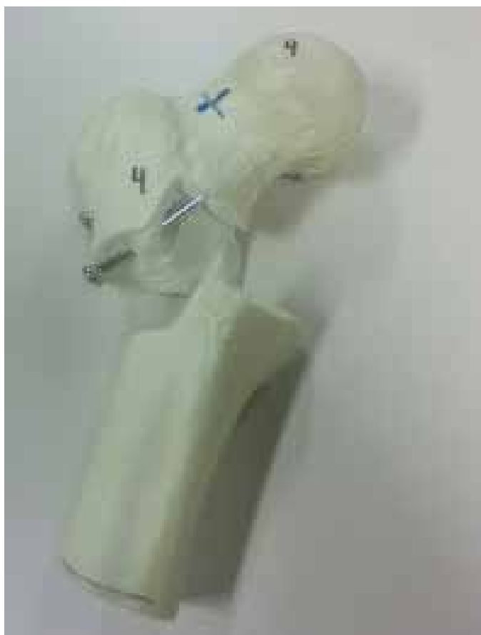
Figura 4 - A – Falha por cisalhamento >5 mm; B – falha por fratura.
